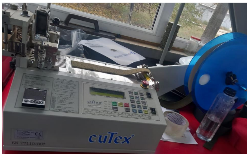
Fig. 12. Mașină automată de tăiat accesorii
