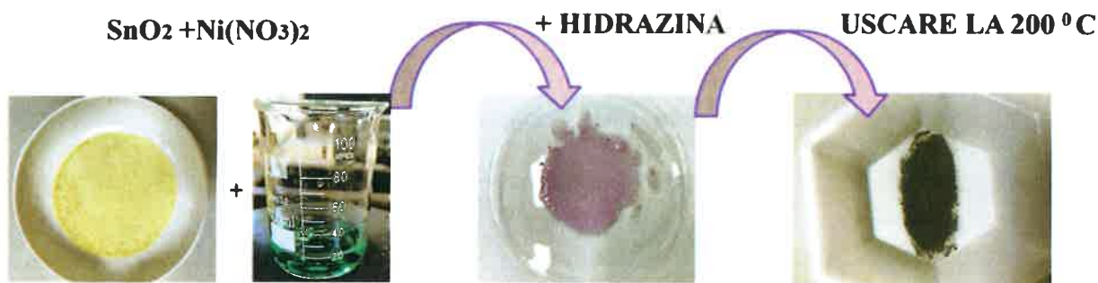
Schema 3. Schema procesului tehnologic de depunere a Ni pe suportul SnO 2 mezoporos
