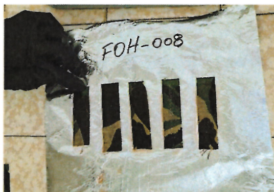
Fig. 10. Depunerea compoziției FOH-008 pe textilul militar prin (a) pensulare; (b) imersare
